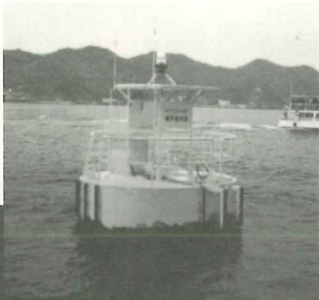
陸からのコントロールで自動給餌をする無人音響給餌機(上)と、その下で天然魚と変わり無く泳ぎまわるマダイ(左)。
